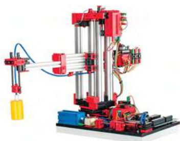
BRACCIO ROBOTICO A 3 ASSI CON PINZA A VUOTO 24V
